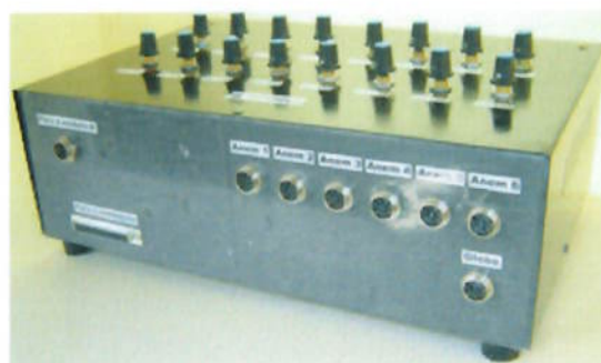
Figura 8.1.3.– Módulo A de aquisição de potência
