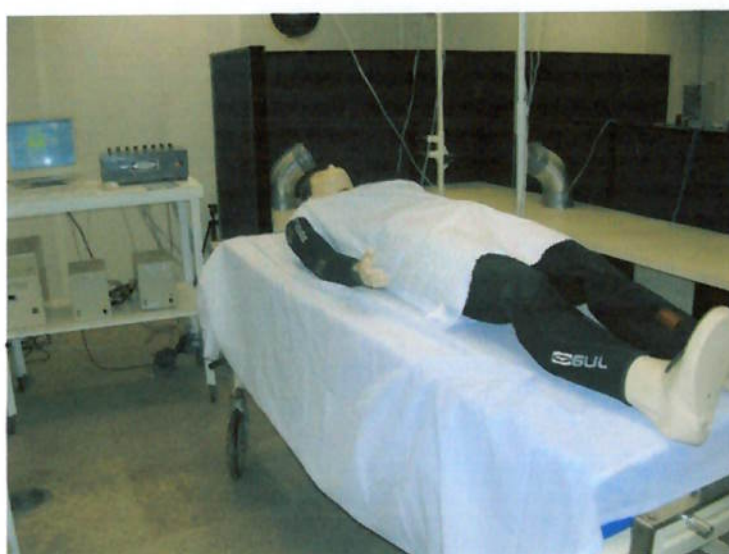
Figura 8.3.1.2. – Ensaio do manequim térmico como paciente vestido no Laboratório de Conforto Térmico.
