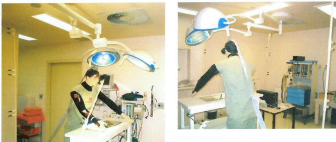
Figura 8.3.4.3. – Posicionamento do cirurgião e da enfermeira (no ensaio a testa foi girada em direção ao foco).
