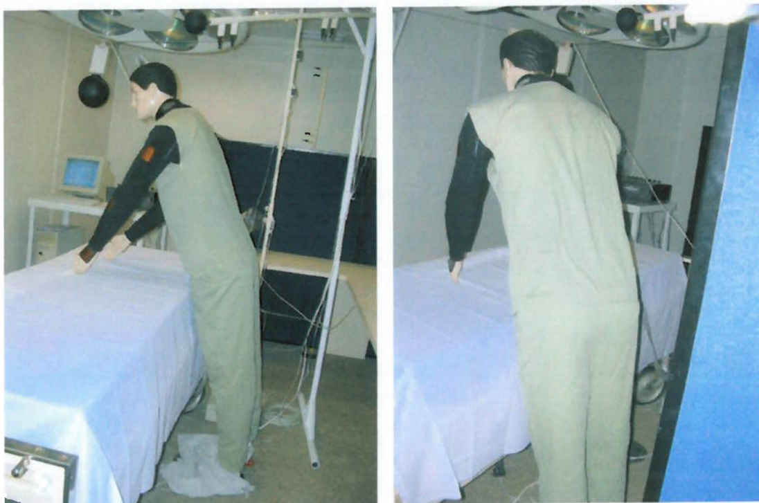
Figura 8.3.1.1. – Ensaio do manequim térmico como cirurgião e enfermeira no Laboratório de Conforto Térmico.
